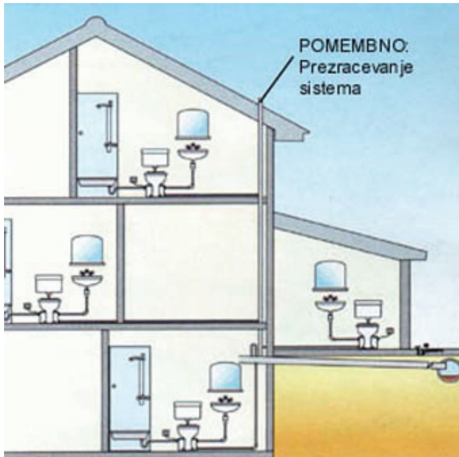
Slika 1: Hišni kanalizacijski sistem z zagotovljenim prezračevanjem
