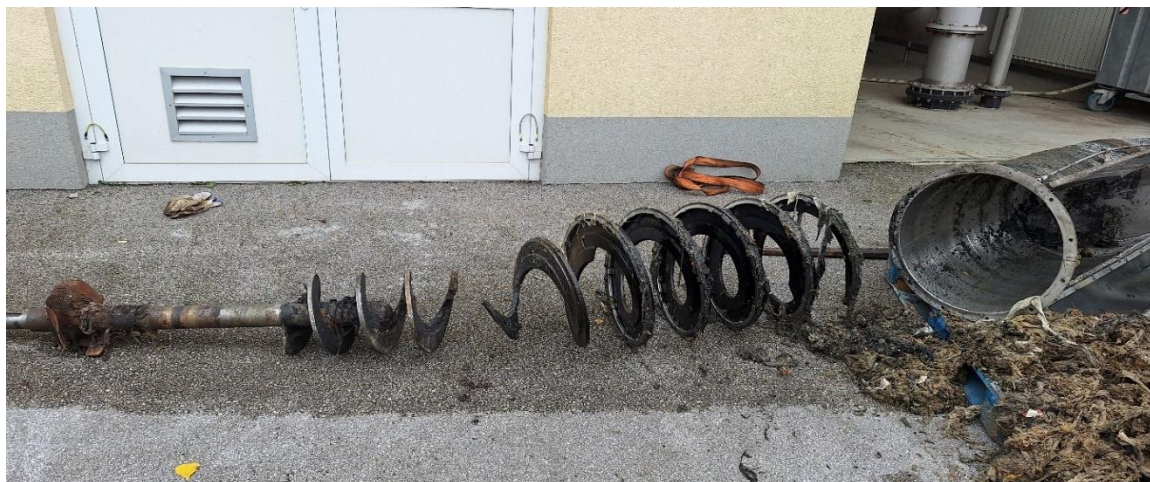
Slika 8: okvara polža mehansko predčiščenje
